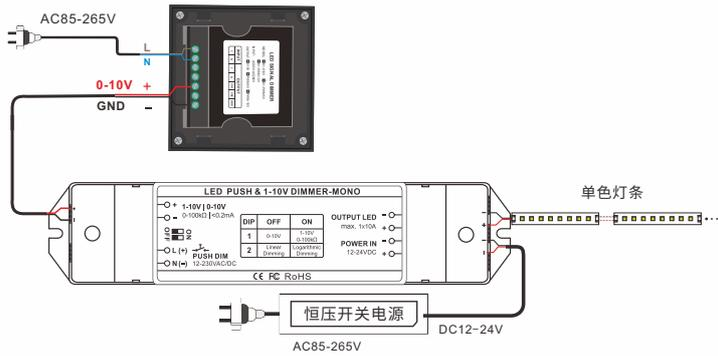
※对于只通过调光信号就能完全关闭输出的调光驱动器或调光电源,可只接调光器的调光信号,而不使用其电压输出。
