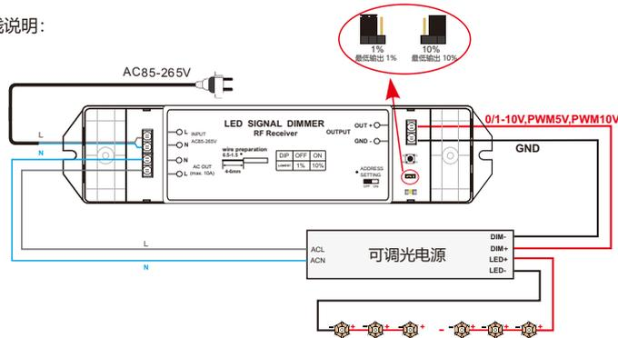
※ 调光器在输出0%的亮度信号时, 会自动切断输出电压, 停止给调光电源供电, 这样可解决市面上部分调光电源通过调光信号不能关断输出的问题。
